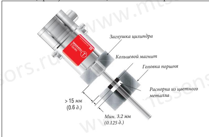
Рис. 2: Модель ТН, тип "Стержень", монтаж
