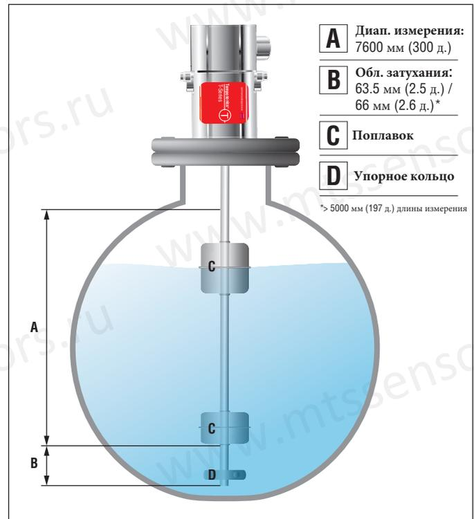
Рис. 4: Монтаж цистерны
