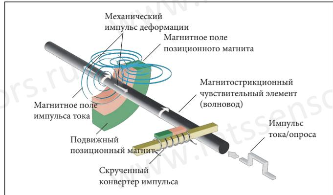
Рис. 1: Магнестрикционный принцип
